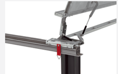
Po odryglowaniu belki zamykającej można, także z otwartą klapą, złożyć belkę zamykającą u góry. Kłapa pozostaje w pozycji otwartej, w ten sposób utrata długości załadowniczej przy załadunku z góry zostaje zminimalizowana.
