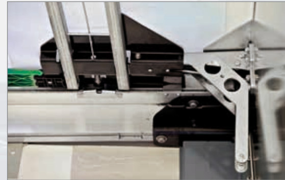
Gasfedern geschützt angeordnet Gas springs in a protected position
