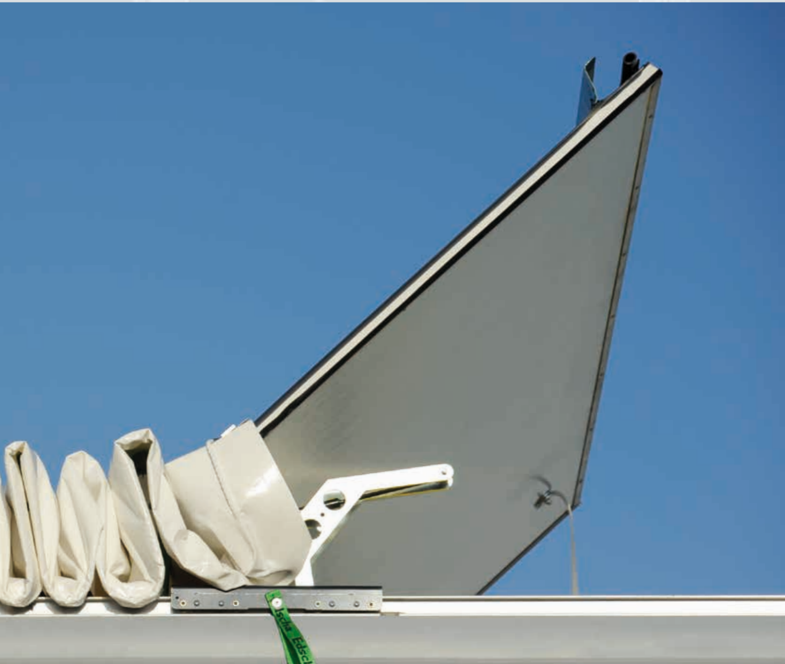
Schließen des TailWing vom Boden oder der Ladebordwand Closing the TailWing from the ground or the tailgate
