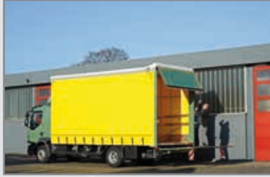
Manuelle Entriegelung und automatisches Aufschwingen des TailWing Manual unlocking and automatic swinging of the TailWing
