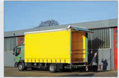
Schließen des TailWing vom Boden oder der Ladebordwand Closing the TailWing from the ground or the tailgate
