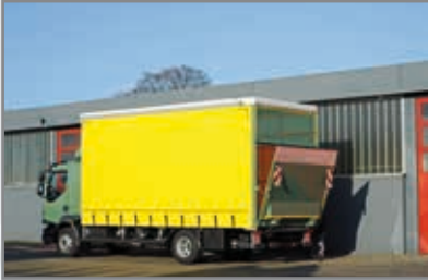
Hydraulisches Öffnen der Ladebordwand Hydraulic opening of the tailgate
