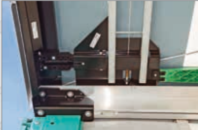
Hinteres Verdeckende mit Edscha TS-Portalbalken, Seilanbindung und Verriegelung Rear end of roof with Edscha TS gantry beam, cable connection and lock
