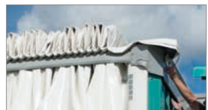
Dachplane lösen Release roof tarpaulin
