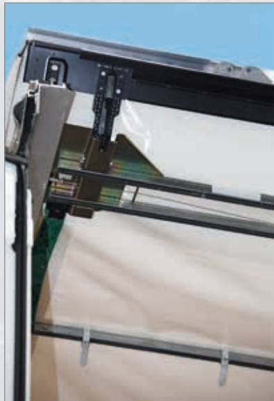
Ausführung Hubdach · Lifting roof design
