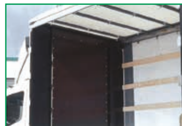
Stirnwand innen flach mit Zurrpunkten und Verschleißschutz komplett vormontiert Inside bulkhead flat with anchor points and protection against wear completely pre-installed
