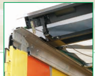
Ausführung Hubdach Lifting roof design
