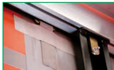
Rungenwagen und Planenroller mit reibungsreduzierender Auflage Pillar glider and tarpaulin roller with reduced-friction support
