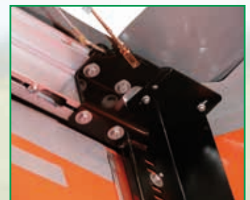
Einbaubeispiel vorderes Verdeckende Installation example of front end of roof
