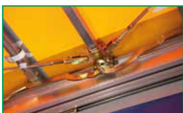
Sondergelenke mit Seilanbindung und Querstange (EN 12642 XL-Version): Special joints with cable connection and transverse rail (EN 12642 XL version)
