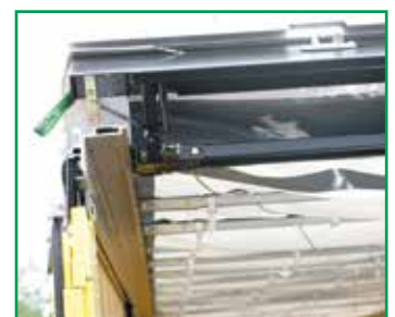
Hinteres Verdeckende mit Edscha TS- Portalbalken, Seilanbindung und Zentrierung Rear end of roof with Edscha TS gantry beam, cable connection and centring
