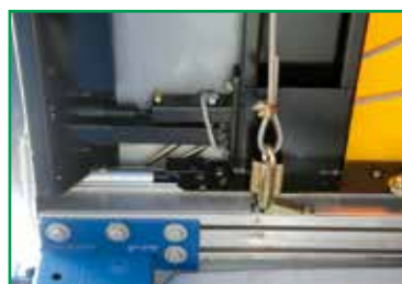
Zugseilverriegelung mit Keil Pullrope closure with wedge
