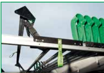
Äußerst haltbare Kunststoffgelenke Extremely durable plastic joints
