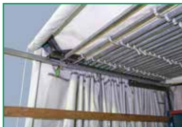
Durch Gelenke zuverlässig gefaltete Plane Tarpaulin folded reliably through joints
