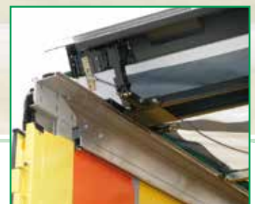
Ausführung Hubdach Lifting roof design
